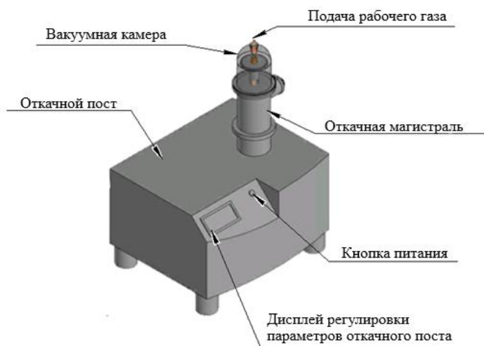
Рис. 9. Эскиз технической системы плазменной очистки с новыми электродами.
