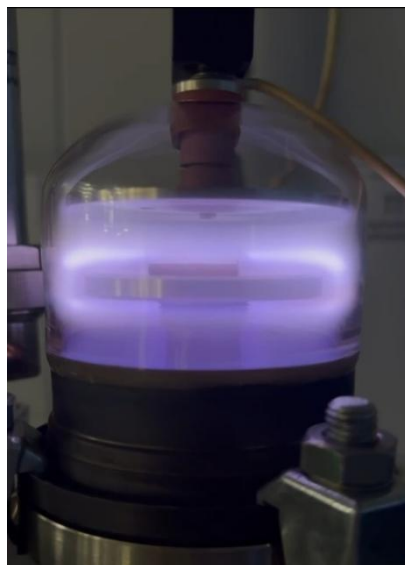
Рис. 3. Процесс очистки детали в плазме тлеющего разряда.
