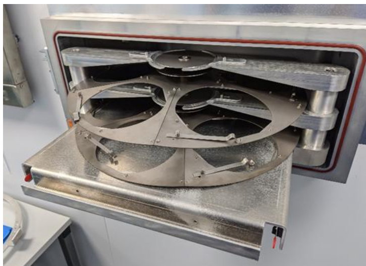
Рис. 3. Шлюзовая камера с выдвинутыми подложкодержателями.
