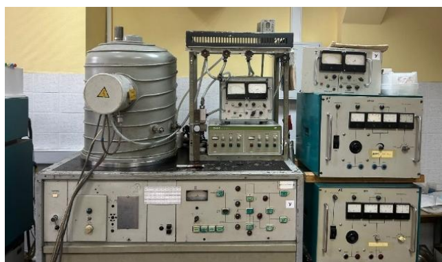
Рис. 1. Установка УВН-71ПЗ с двумя источниками ионов
