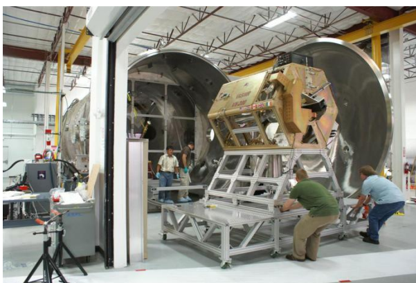
Рис. 4. Процесс установки ПРД VASIMR 200 кВт в двигательный отсек камеры “El Monstruo”.
