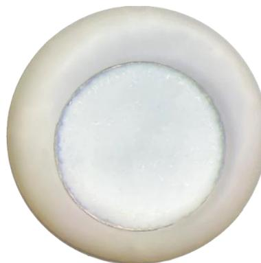
Рис. 2. Катод с нанесенным карбонатным покрытием
