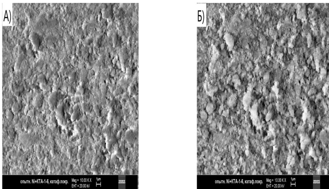
Рис. 6. Поверхность покрытия (а) до активирования и (б) после активирования катода
