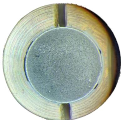
Рис. 1. Катод, синтерированный никелевым порошком
