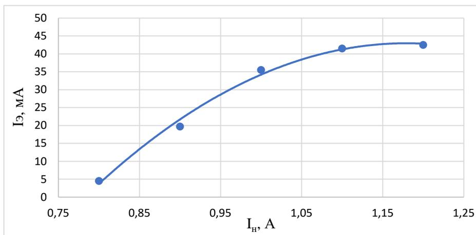
Рис. 5. Зависимость тока термоэмиссии катода от тока накала
