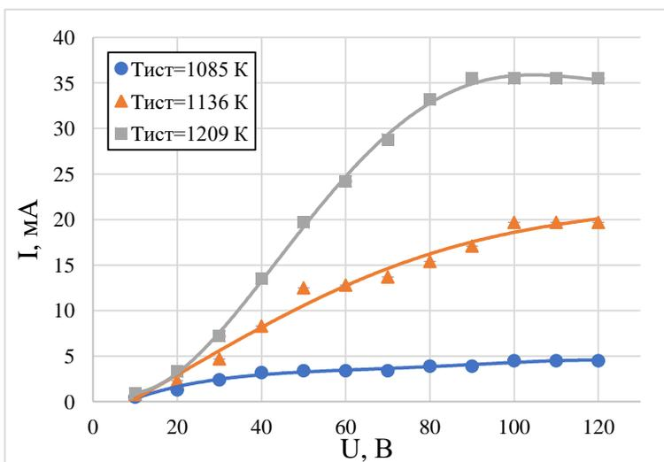
Рис. 4. Вольтамперные характеристики катода при различных температурных режимах
