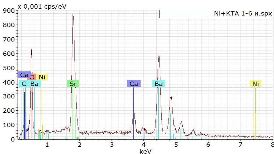
Рис. 7. Элементный состав поверхности катода до активирования
