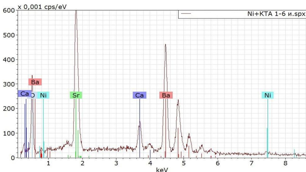
Рис. 8. Элементный состав поверхности катода после активирования
