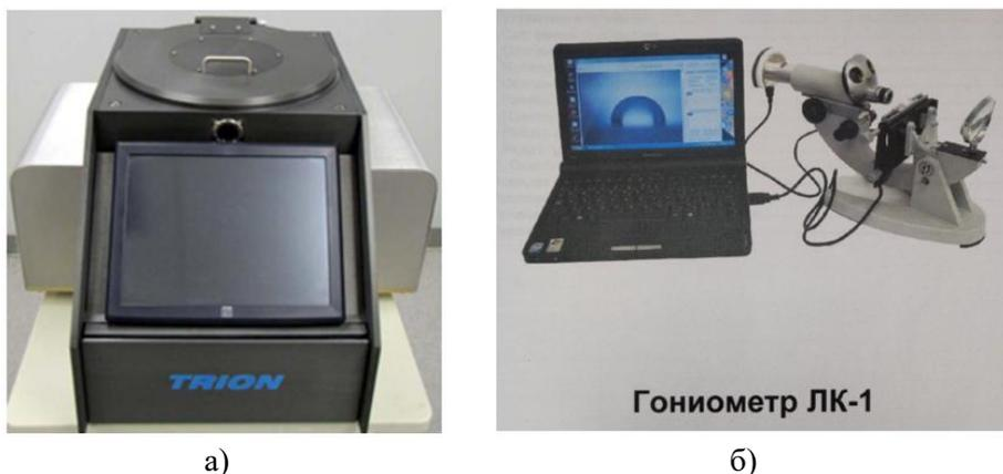
Рис.3. Установка плазменной обработки (а) и гониометр (б)
