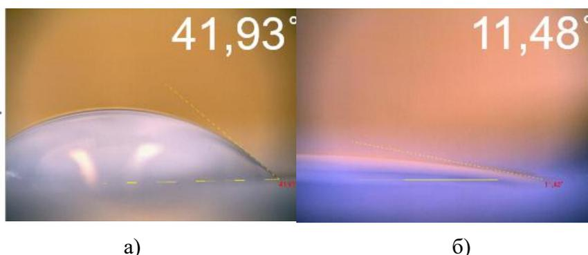
Рис.5. Угол смачивания керамической пластины до (а) и после (б) плазменной обработки в смеси газов аргона и кислорода
